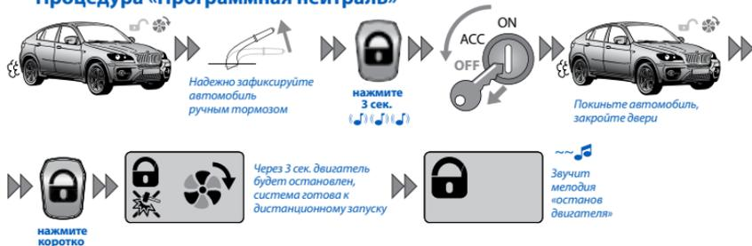
В случае если предполагается использовать дистанционный или автоматический запуск двигателя на автомобиле с МКПП, то перед постановкой автомобиля на охрану необходимо выполнить следующую последовательность действий:
