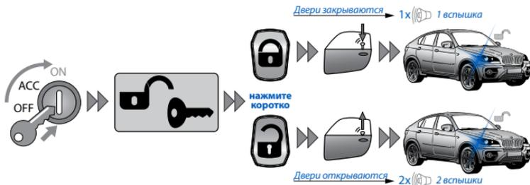
Запирание и отпирание дверей можно производить принудительно с брелока без постановки на охрану при включенном зажигании. Для этого при включенном зажигании коротко нажимаете кнопку - двери при этом закроются, а нажатие кнопки откроет замки дверей.
