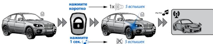
Для того чтобы облегчить поиск своего автомобиля на крупной автостоянке, коротко нажимаете на кнопку во время, когда автомобиль находится под охраной, система выдаст 5-кратный звуковой сигнал sireны и пять вспышек указателей поворота.
